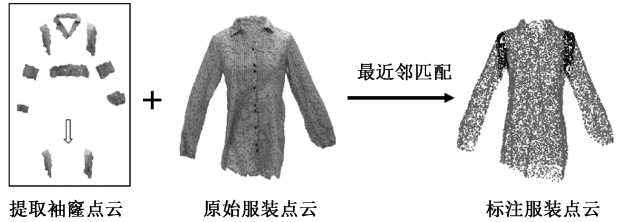
图 2 点云标注方法示意图
