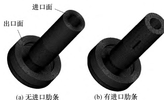
图3 离心泵整体网格示意图
