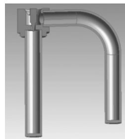
图1 电子膨胀阀三维剖面
