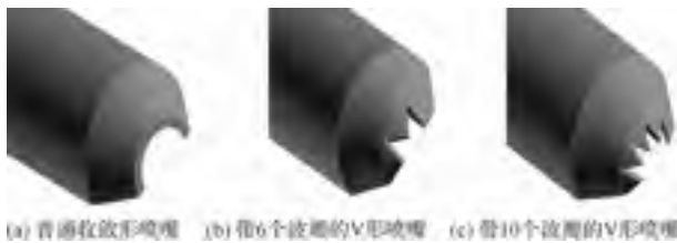
图 2 喷嘴的几何形状三维展示图
