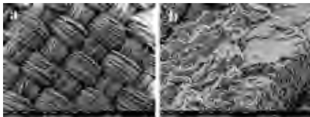
图2 剥离光子晶体后蚕丝织物表面形貌的 FESEM 表征(a为放大100倍的蚕丝表面,b为放大5 000倍的纤维缝隙形貌的 FESEM 图)
