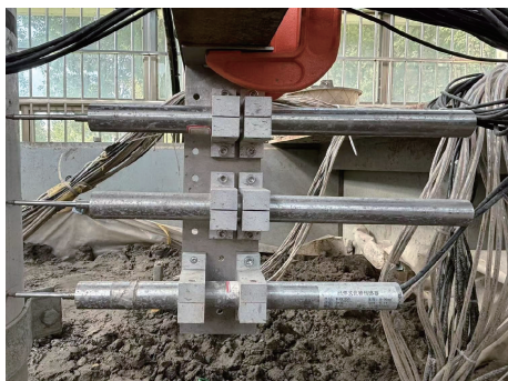
图2 LVDT位移传感器实拍图
