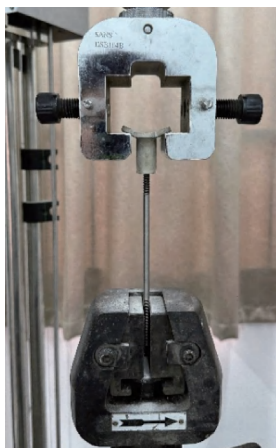
图5 连接件尾盘受拉照片
