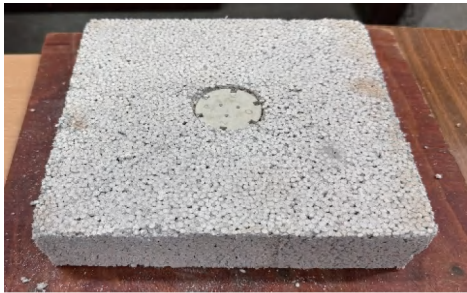
(a) 拆除固定装置后热固板受拉特征照片
