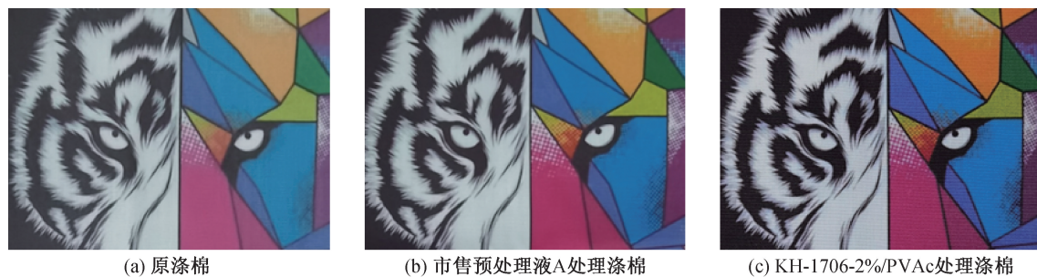
图 8 不同预处理液处理织物的图案打印效果
