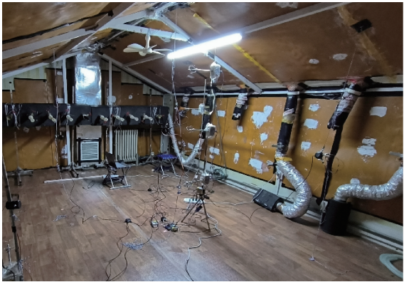
图 1 大空间喷口送风缩尺实验室照片
