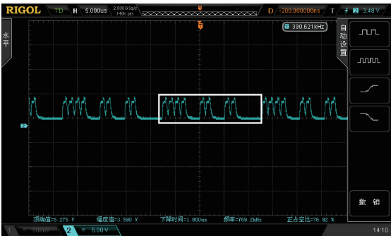
(d) 十六进制数d4的LED两端信号
