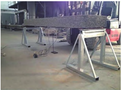
图 4 试件的抗弯性能试验装置照片
