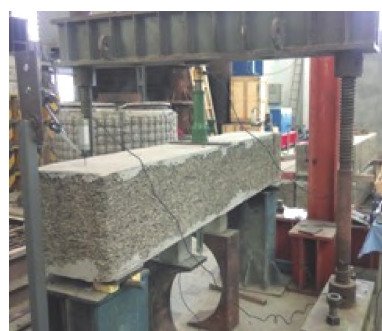
图 2 3 点抗折加载试验加载方式示意图
