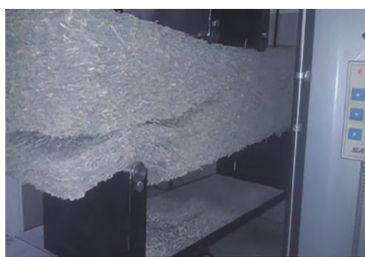
图 9 抗折试件破坏时的照片
