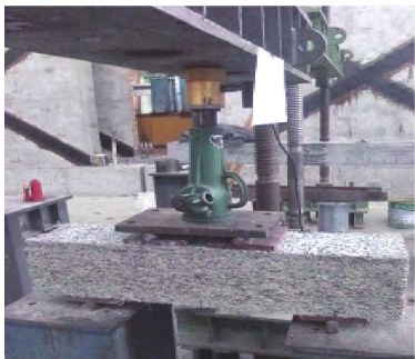
图 3 4 点抗折加载试验加载方式示意图
