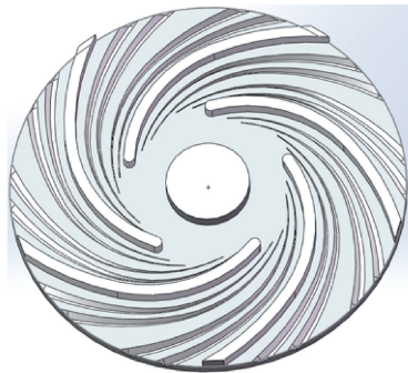
(b) 三角形仿生微槽结构示意图
