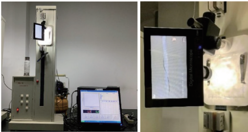
图2 复合纱力学性能及形态测试装置
