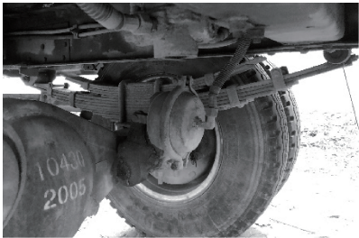
图 1 纵置板簧在汽车中的位置
