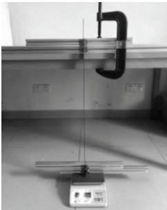
图9 剑带失稳实验照片
