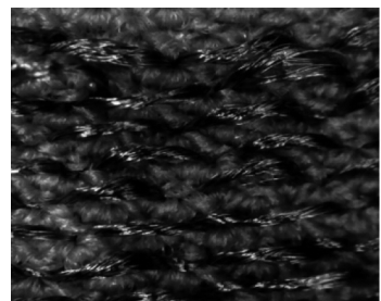
图5 111.1 dtex 镀银纱线在织物表面的形态
