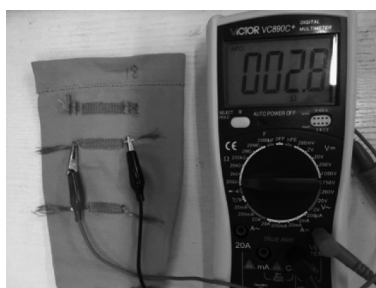
图1 万用电表测试传感器电阻实验图
