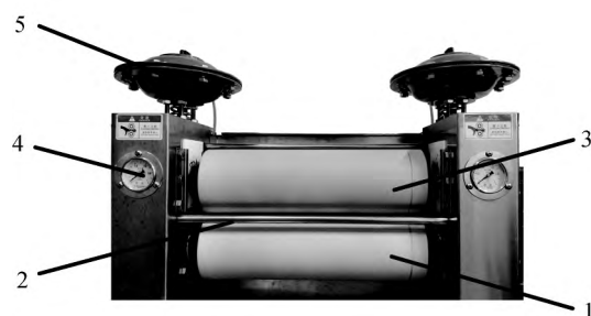
1—下轧辊;2—湿织物入口;3—上轧辊;4—压力表;5—加压气缸 图2 立式小轧车照片
