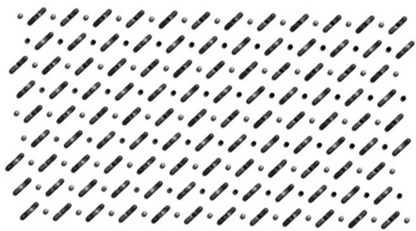
图 1 方解石(104)晶面(圆点代表 \text{Ca}^{2+} ,粗短线代表 \text{CO}_3^{2-} )
