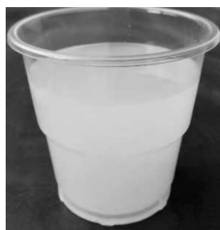
(a) OTMS 表观锚固密度为 0 \mu\text{mol} \cdot (\text{m}^2 \cdot \text{TiO}_2)^{-1} 的模板浸泡液
