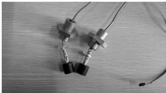
图6 超声压电换能器
