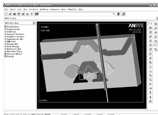
图 2 横机三角三维模型
