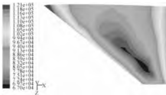
图7 机翼上蒙皮在某时刻的压力分布
