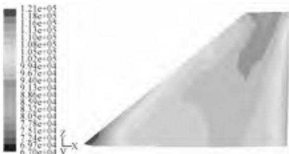
图8 机翼下蒙皮在某时刻的压力分布
