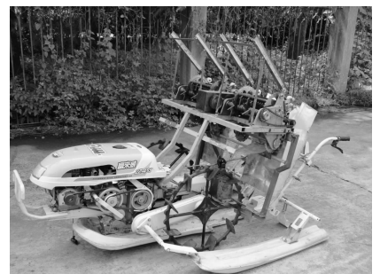
图 6 凸轮杠杆顶出式水稻钵苗移栽机
