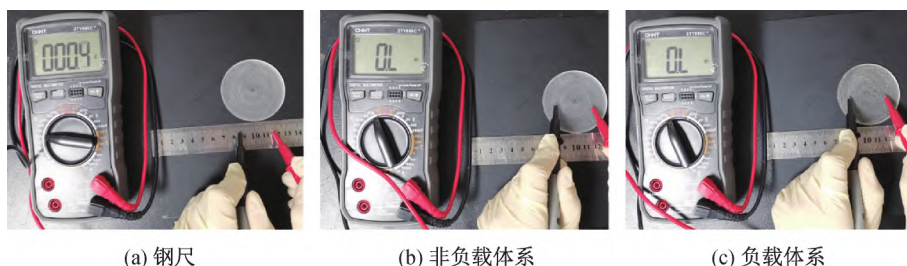
图 10 无溶剂有机硅树脂固化后的电阻测试照片
