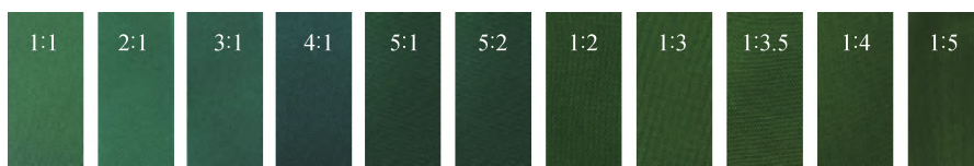
图 8 D_{65} 光源下 C.I.分散蓝 77 与 C.I.分散黄 54 不同复配比下的染色涤纶织物照片
