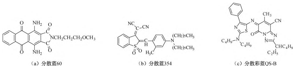
图 1 3 种蓝色分散染料的分子结构式
