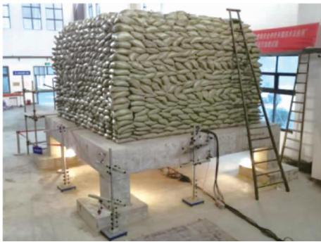
图5 试验堆载现场照片 [5]
