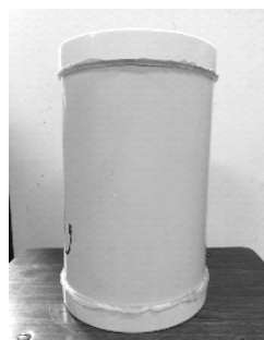
图 2 聚氯乙烯(PVC)密封桶
