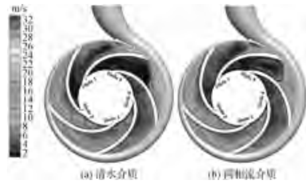
图 3 设计工况下相对速度流线分布
