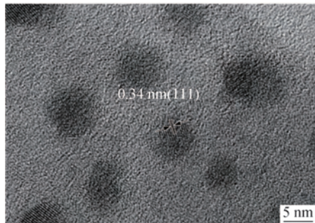
图 1 \text{CsPbBr}_3 量子点的高分辨率透射电镜图
