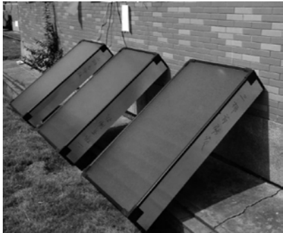
图 5 V 型孔板渗透式太阳能空气集热器实验测试现场
