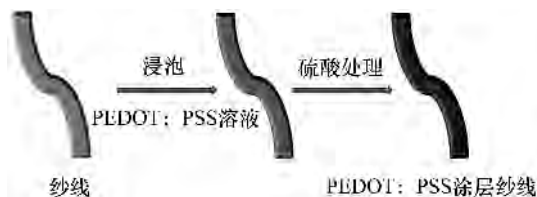
图3 导电 PEDOT:PSS 涂层纱线的制备过程
