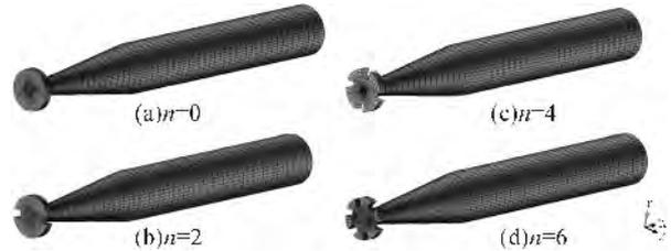
图5 不同凹槽数空化器航行体网格划分情况示意
