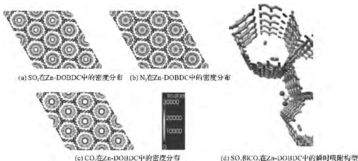
图7 313 K及0.1 bar时烟道气中 \text{SO}_2 、 \text{N}_2 和 \text{CO}_2 在Zn-DOBDC材料中的密度分布以及 \text{SO}_2 和 \text{CO}_2 在Zn-DOBDC中的瞬时吸附构型
