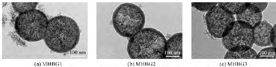
图5 不同粒径的介孔镂空生物玻璃球的透射电镜图
