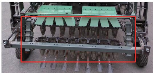
图 15 八行植苗机构实物样机照片
