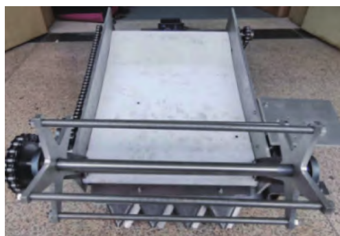
图12 芹菜收获机样机照片
