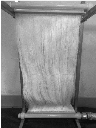
图 1 中空纤维膜除湿组件实物照片
