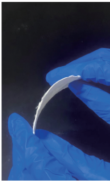
(c) 竹纤维/SiO 2 复合膜弯曲照片
