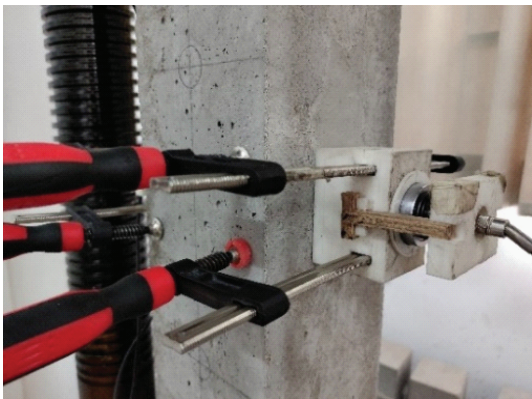
图 3 水平方向夹具照片
