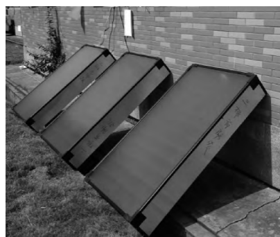
图 5 V 型孔板渗透式太阳能空气集热器实验测试现场
