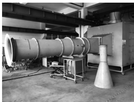
图3 无蜗壳离心通风机测试台装置照片 [17]
