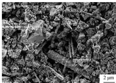
图8 SiC 纳米纤维陶瓷素坯显微结构
