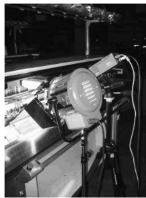
图10 横机高速摄像实验装置
