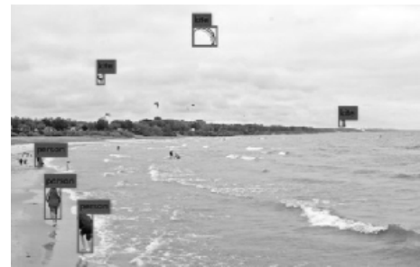
图8 YOLOv2 网络检测结果
