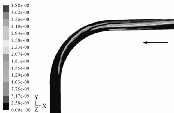
图5 管道5处壁面磨损分布局部放大
