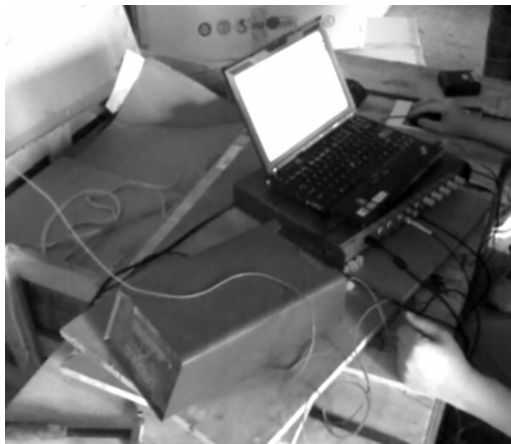
图 5 模态分析实验设备系统组成
